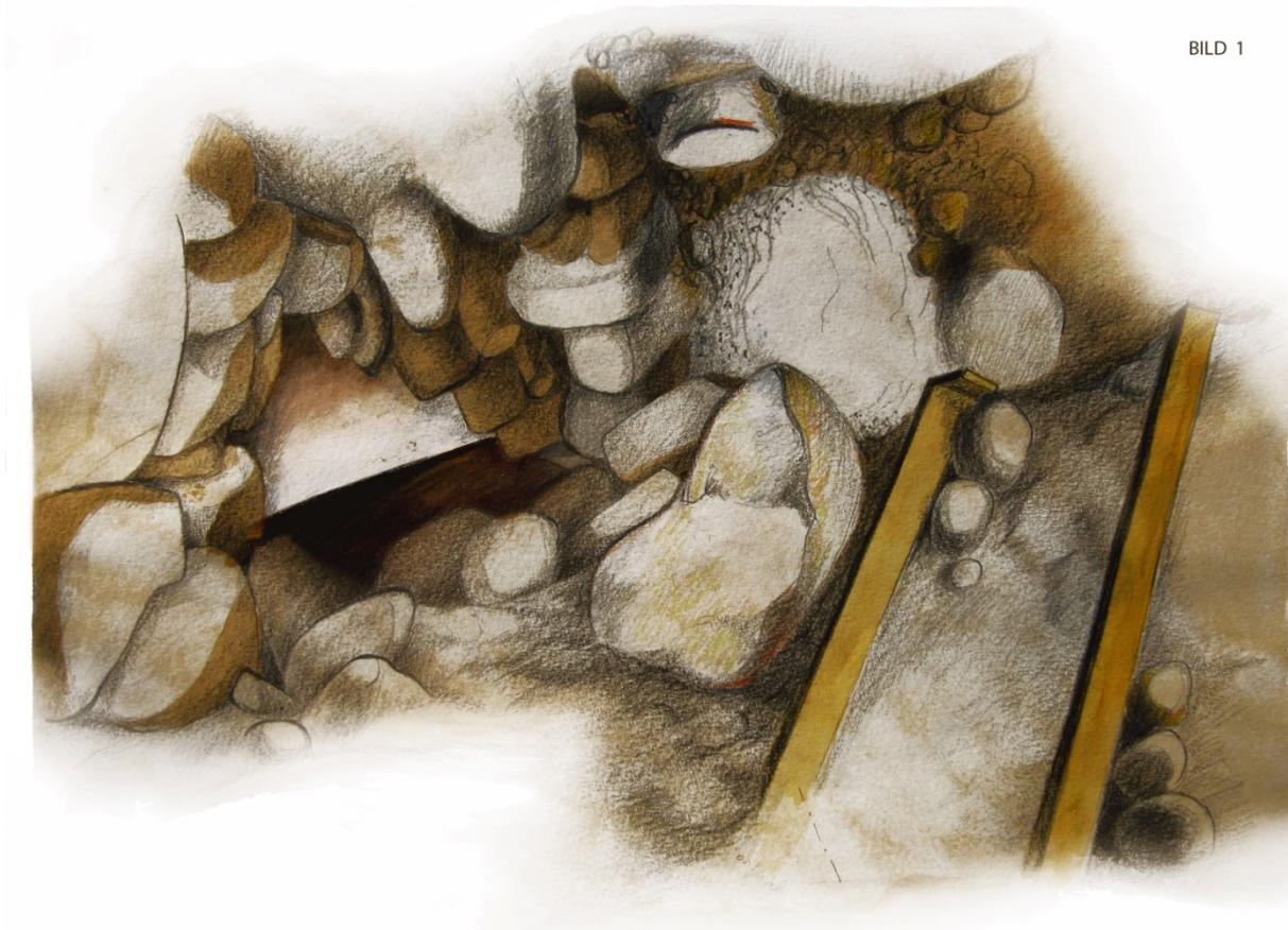
Eine praktikable Alternative zur Sicherung des bestehenden Zustandes stellt die Stabilisierung der Ausbrüche und lockeren Bereiche mittels Spritzbeton- bzw. Spritzmörtelverfahren dar. Siehe auch Bild 2. Vorgesehen ist das Trockenspritzverfahren, mit welchem gute Festigkeiten mit hoher Verdichtung des aufgespritzten Mörtels in den Abbruchkanten
