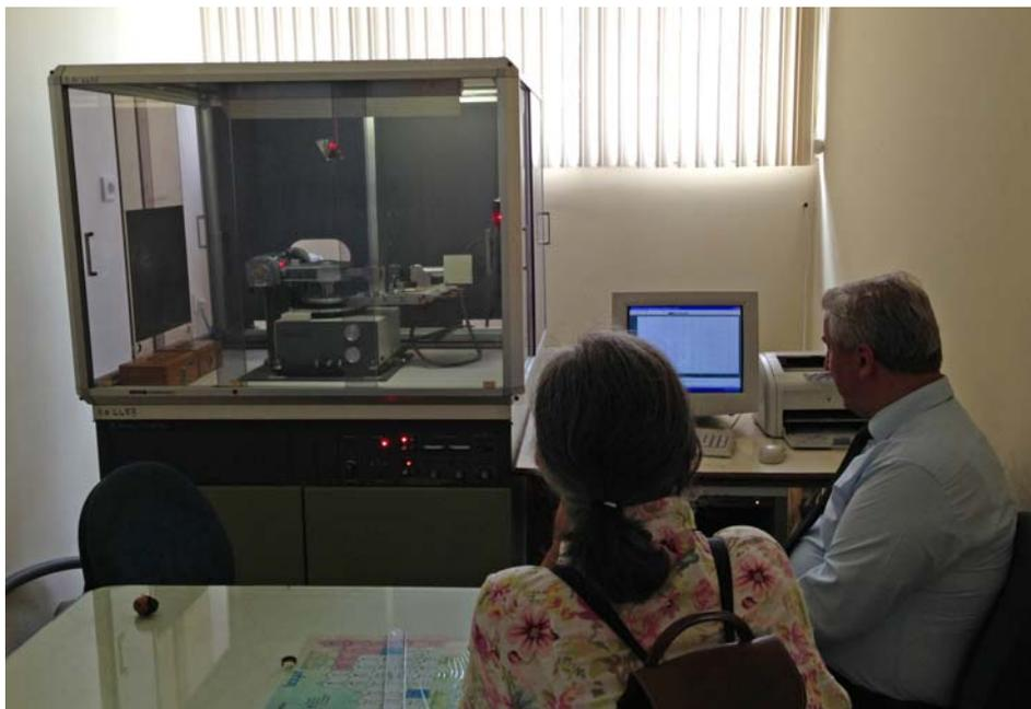
**Abbildung 12: RIGAKU Geigerflex Röntgendiffraktometer im Physikalischen Institut der KTU (im Hintergrund: Prof. Dr. Ekrem Yanmaz)**
